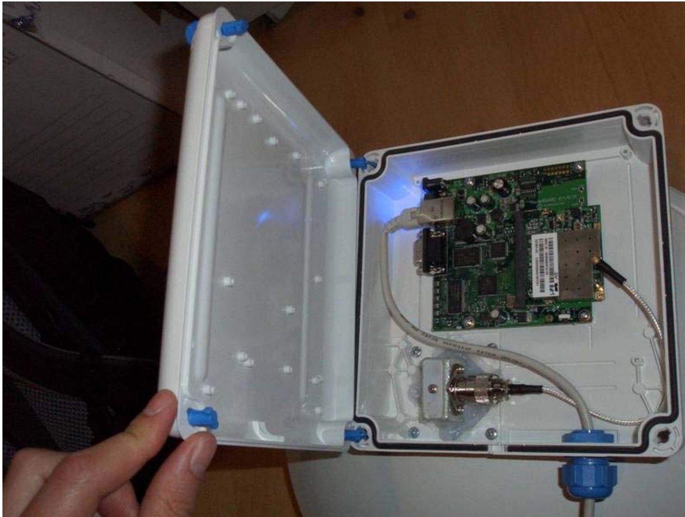
Mikrotik RB411AH, Wistron DCMA-82, 24dBi parabolic antenna (9°h, 9°v) http://db0fhn.efi.fh-nuernberg.de/doku.php?id=projects:wlan:hamnet
